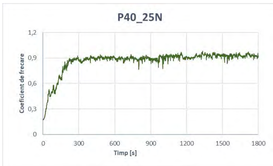
Fig. 10 Evoluția în timp (30 min) a coeficientului de frecare la o forță aplicată de 25N și o turație de 300 rpm
