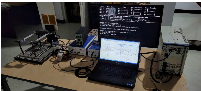
Echipament pentru culegerea datelor spectrale de vibrație a modelului de aripă: PC plus placa de achiziție NI, amplificatoare TREK, actuator MFC excitatie și respective control, accelerometru B&K, preamplificator integrator, model de aripă cu actuatori MFC
