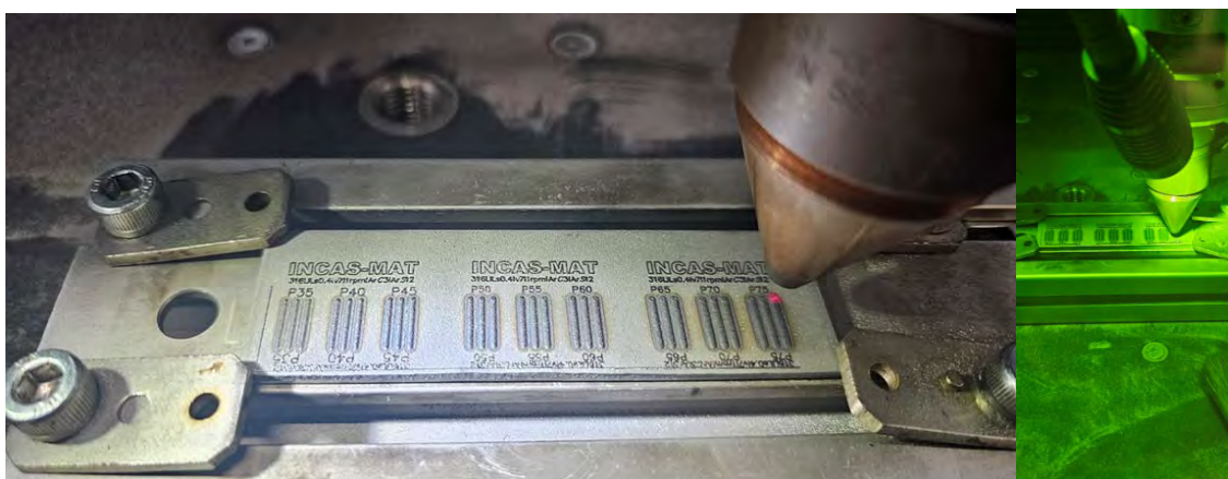
Figura 2 Depunere cu inox 316L pe substrat de inox 304.
