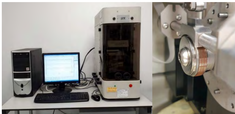
Fig. 9 Tribometrului Universal CETR UMT-3 Bruker din cadrul Laboratorului de Materiale și Tribologie, INCAS București
