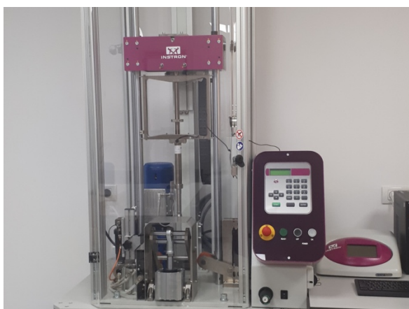
Figura 4 Testarea la impact a compozitelor (Echipament din cadrul laboratorului de materiale și tribologie INCAS București)
