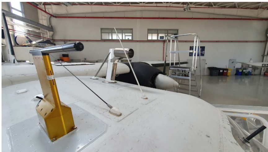
Figura 1. Sistemul CWIP instalat pe aeronava BN2A-27
